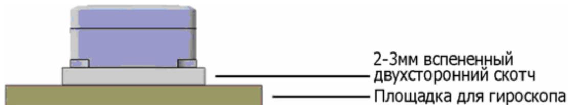
Установка на больших вертолётках или вертолётках с высокой вибрацией: используйте 2-3мм вспененный двусторонний скотч с каждой стороны защитной демпфирующей пластины.
